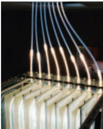
Ослепительно яркие панели, к которым свет подводится по оптоволоконным кабелям, чередуются в биореакторе с мембранными пластинами, покрытыми сине-зелеными водорослями.
